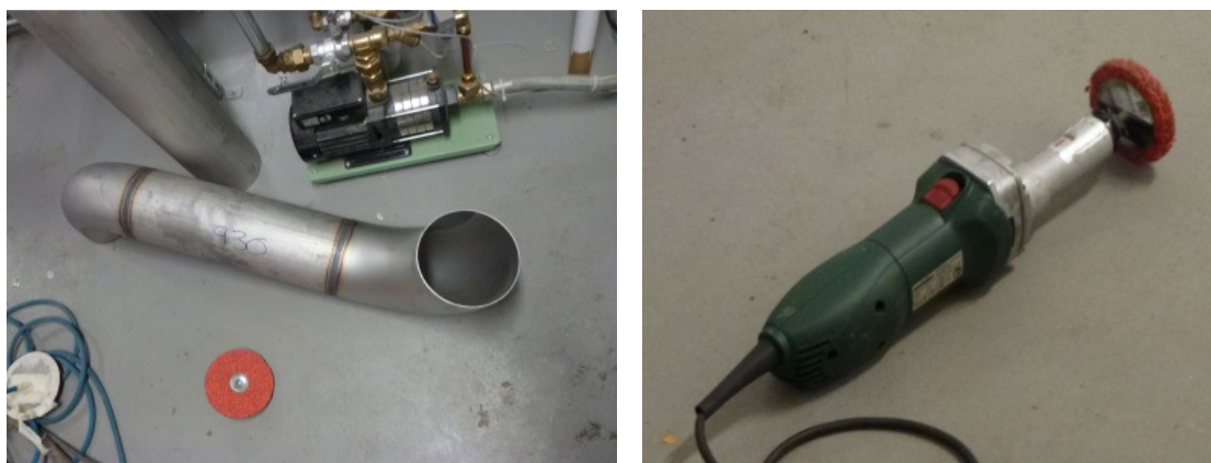
Bild 1-2 visar kvarvarande svetsoxid och det putsverktyg som är vanligt för att avlägsna svetsoxiden.
