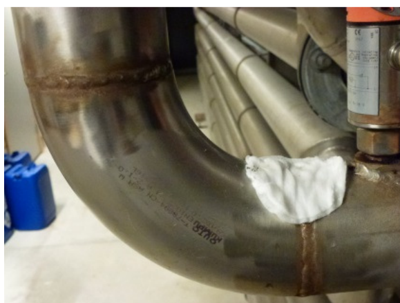
Bild 17-18 Simhallsmiljö. Otillräckligt avlägsnad svetsoxid. Korrosionen har i detta fall startad från insidan, vattensidan
