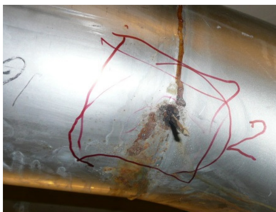
Bild 17-18 Simhallsmiljö. Otillräckligt avlägsnad svetsoxid. Korrosionen har i detta fall startad från insidan, vattensidan
